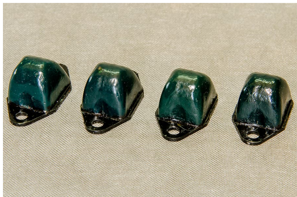
Odboje przedniego górnego wahacza L-200
